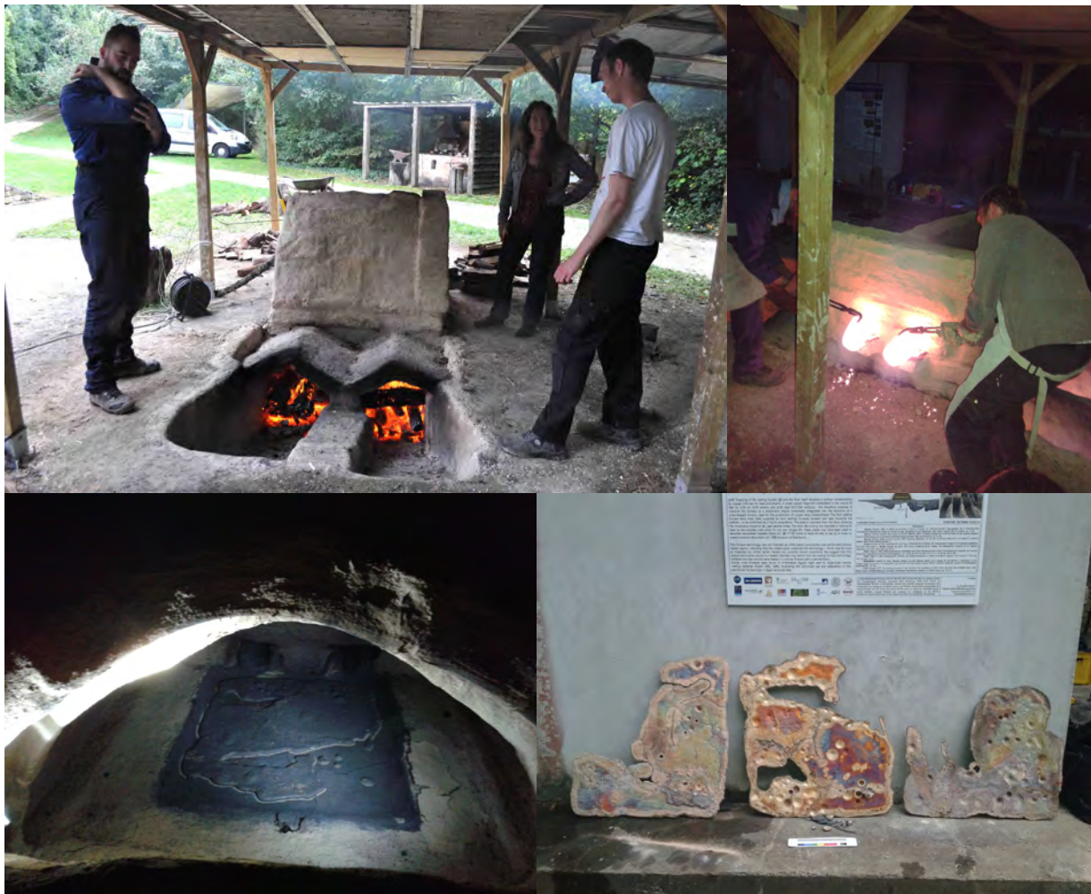
Fig. 27. Première coulées de plaques de bronze dans le four de Kerma reconstitué, plate-forme expérimentale de Melle (28-29 septembre 2019), (© Mission Kerma-Doukki Gel).
